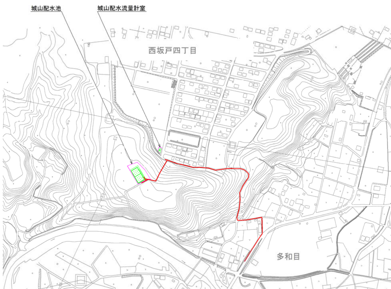
図 6-6-2 城山橋から城山配水池送水管布設替工事ルート図
