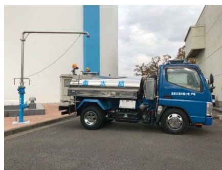
図 4-27 緊急時給水栓と給水車
