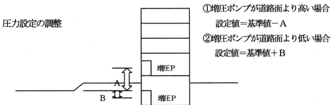
図 6-14 直結増圧方式の動水勾配概念図
