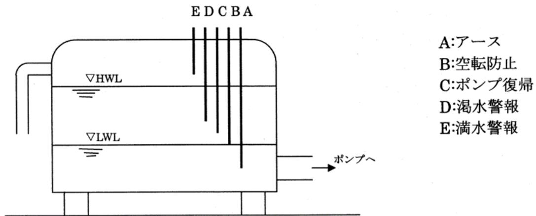
図 6-22 受水槽標準構造図
