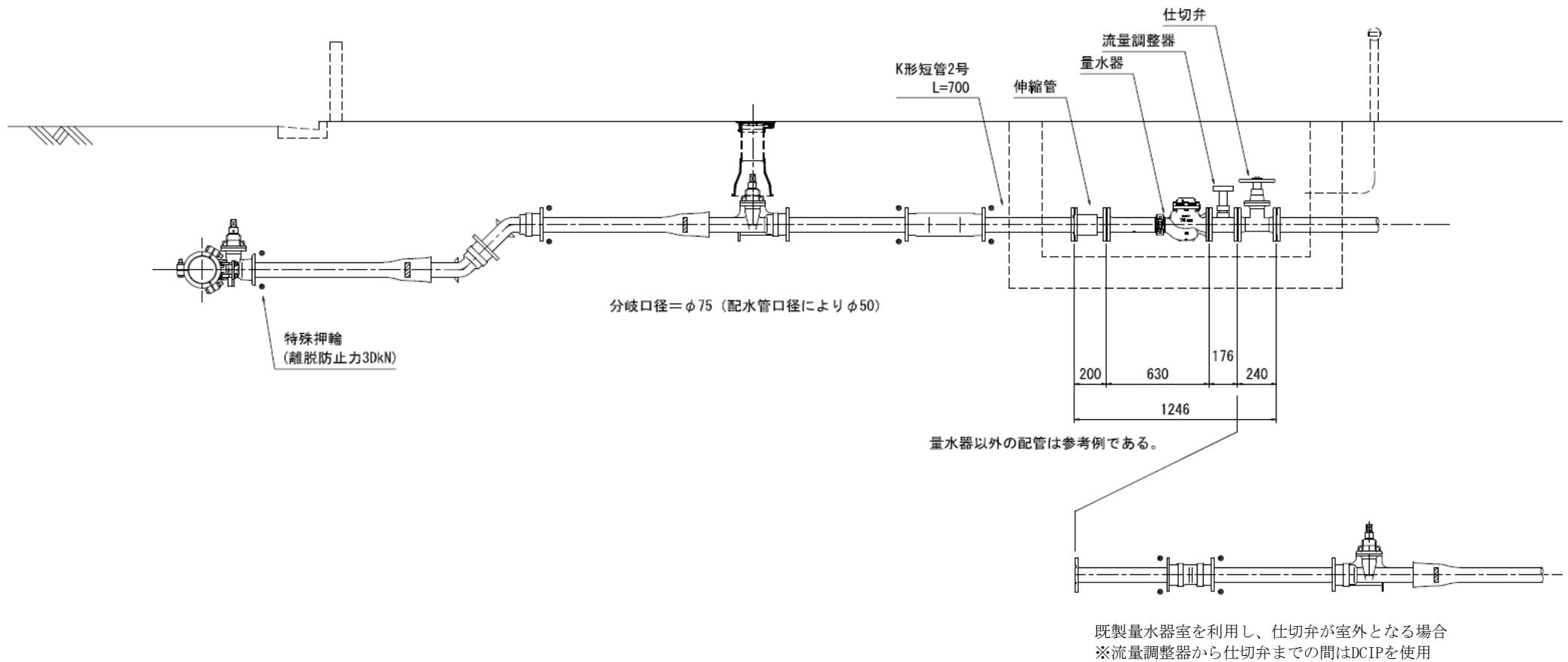
給水装置標準図（分岐・メータ一口径  $\phi$  75-HPPE）
