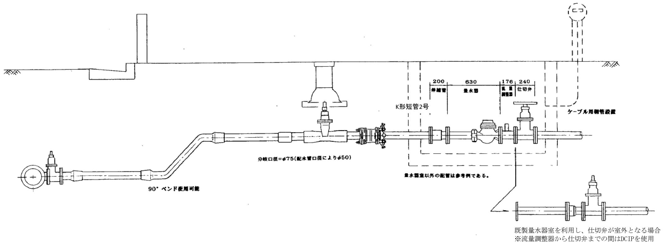
給水装置標準図 (電磁式メーター  $\phi$  50・75-DCIP)
