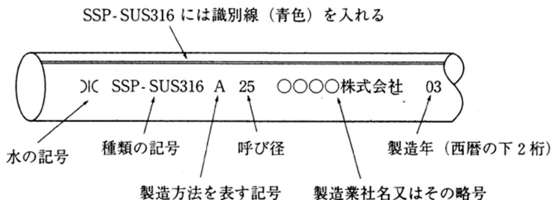
図 3-7 ステンレス鋼管継手
