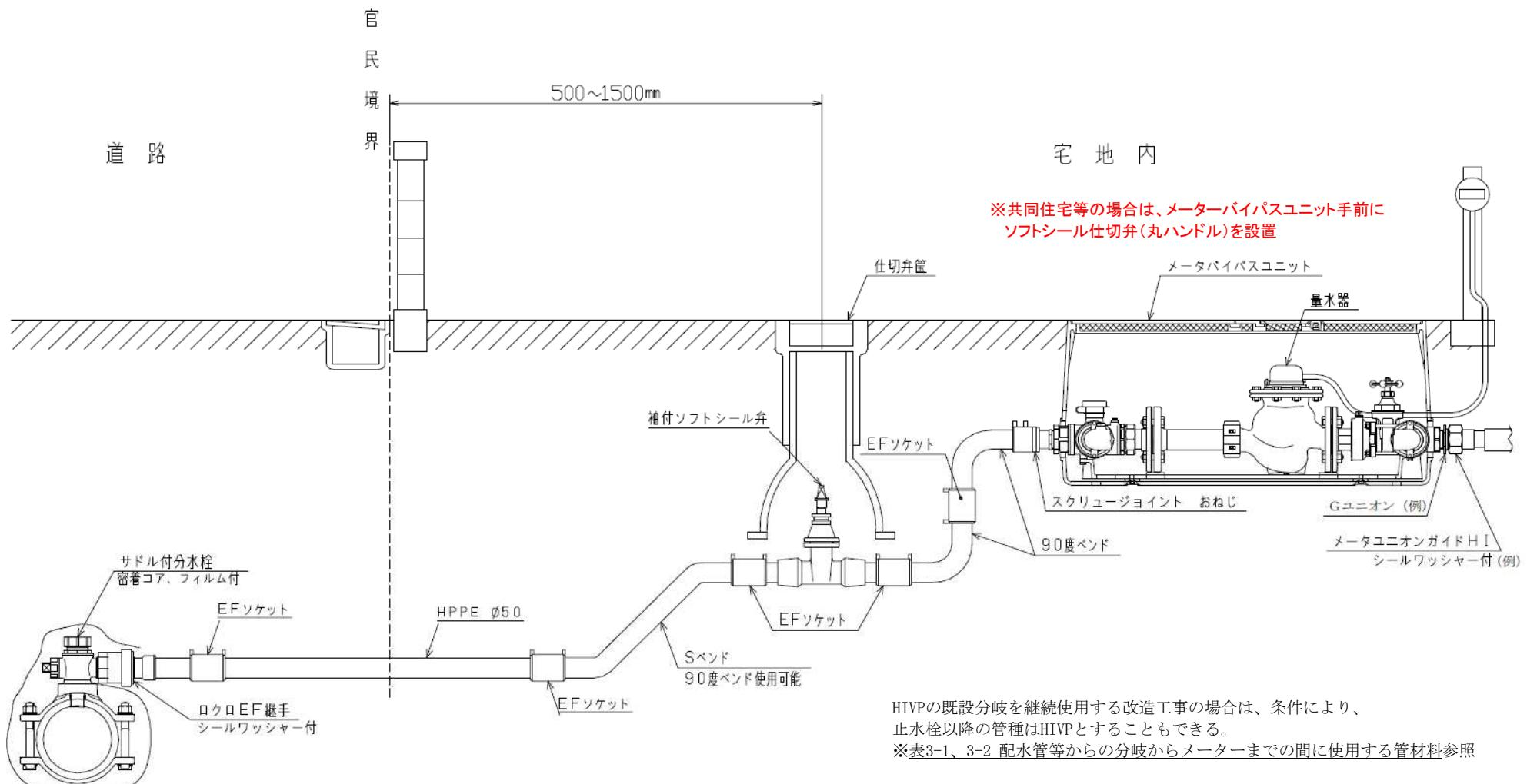
給水装置標準図（分岐・メータ一口径  $\phi$  75-DCIP）
